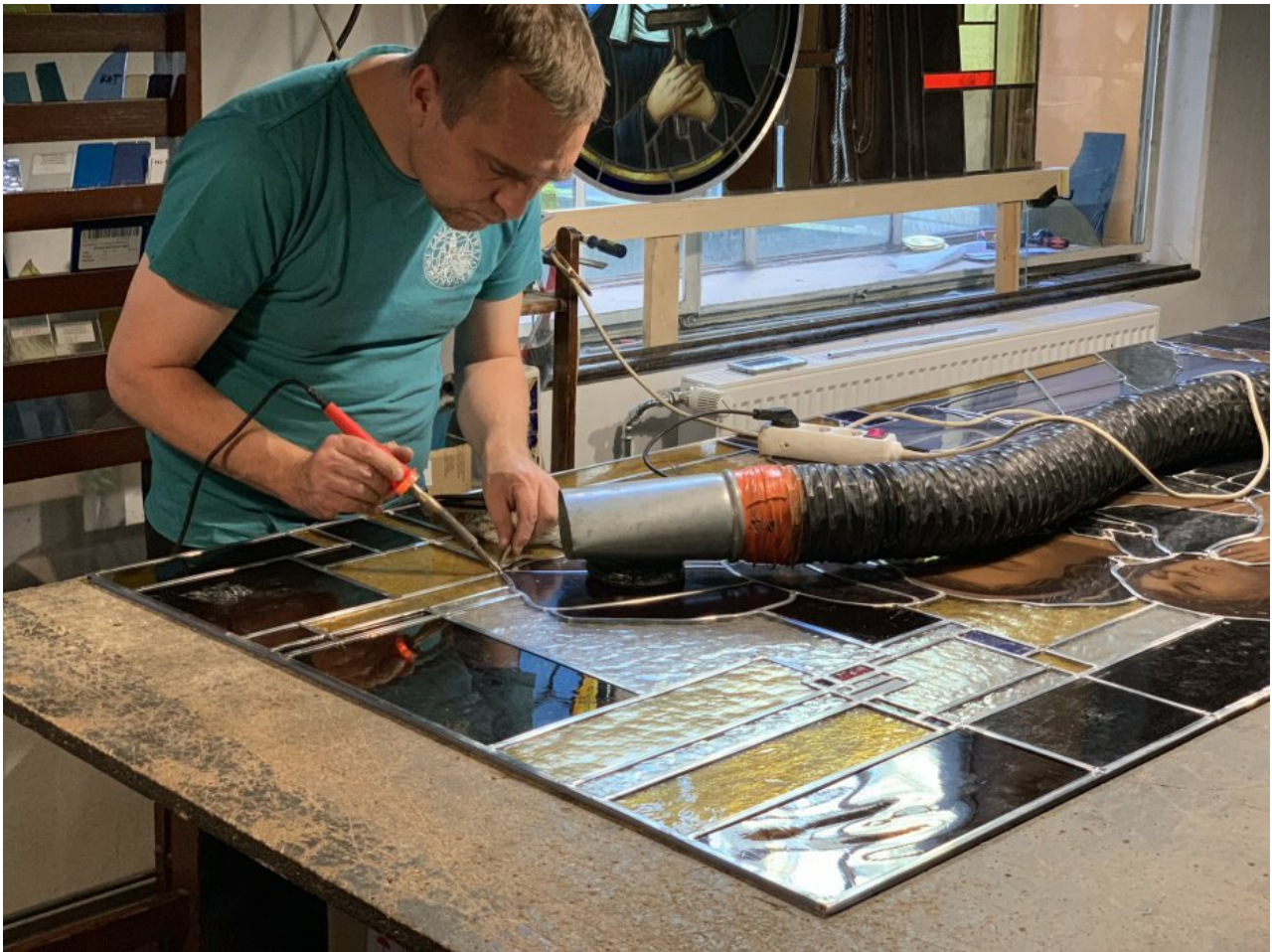
Sertissage du vitrail ou "mise en plomb" (photo de Richard)
